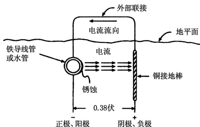
附图显示铜与铁电气联接时形成化学电池的效果,铁可能是地下钢铁,管线,或水管,铜是接地网,,外部联接可能是管线铁架,或通过接地网直接联接到管线。根据欧姆定律,通过土壤电解质形成环路,产生电流,此时电流从阳极铁离开进入土壤后,即对铁产生腐蚀。据试验;1 安培直流电流经过 1 年将腐蚀掉 20 磅重铁,75 磅重铅,26 磅重锌,如果环路电流加大,将有更多金属被腐蚀掉。两金属间电极电势及其间的电阻,决定其电流大小。根据金属电极电势表,金属在正极端时为阳极,这些金属将被腐蚀,金属在负极阴极端时是负值,这些金属将被保护,因此叫“阴极保护”“金属在阴极,它被保护,因而不腐蚀。有铜接地网存在时,铁在正极端被腐蚀,铜在负极端被保护。镀锌铁棒不用于接地网,因其上锌将很快被腐蚀掉,并露出铁,也将很快被腐蚀。根据文献 6 的测试及文献 10 的说明,如果铜接地网同其他金属,如黑铁,铸铁,可锻铁进行电气互联时,铁金属将成为铜的阴极保护消耗材料。因而铜是坏邻居,当铜接地网存在时,将对同时接地的其他铁金属加速腐蚀。
